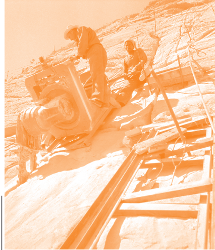
Il taglio dei blocchi per mezzo di seghe a catena a motore
